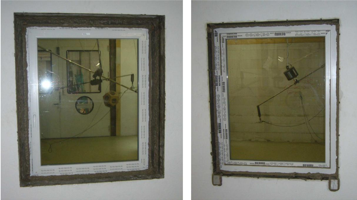
**Bild 1** Fotos des Prüfelements, erstellt vom ift Schallschutzzentrum, links vom Empfangsraum, rechts vom Senderaum aus gesehen.
